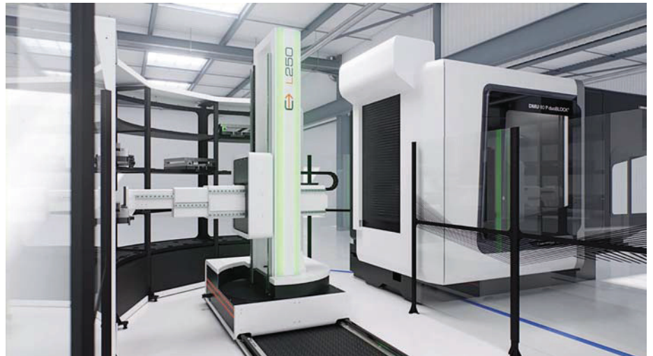
Cellule automatisée constituée d'un robot Easybox L-250 avec contrôle tridimensionnel CN sur 2 DMU 80 P duoBlock.
